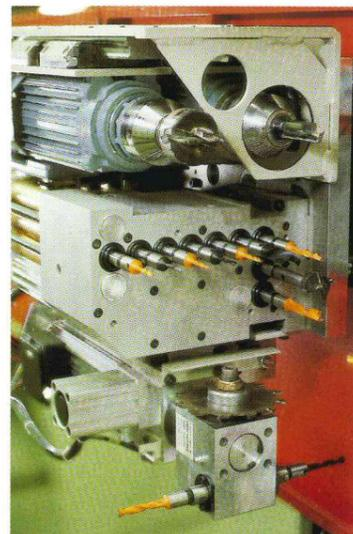
Leistungsstarke Fräsaggregate, 9- oder 13-spindliges Bohrreggat, integrierte Stirnbohrereinheit mit Nutsäge.
