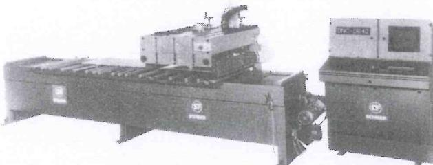
Füge- und Feinschnittmaschine FM 18 mit starrem, pneumatisch betätigtem Spannbalken; zum fugendichten und splitterfreien Sägen von Furnieren und Platten.
