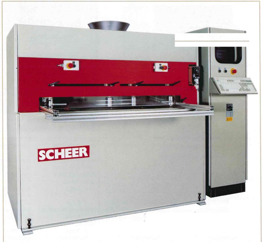
Auf diese Maschine haben Sie schon lange gewartet. Hiermit lösen Sie den Engpaß beim stirnseitigen Bohren und Dübeleintreiben. Flexibilität und Schnelligkeit macht den Dübelspecht jedem Bearbeitungszentrum beim horizontalen Bohren überlegen. Die Dübel werden mit exakter Leimdosierung paßgenau eingebracht. Dadurch verschaffen Sie sich einen enormen Produktivitätsvorsprung.
