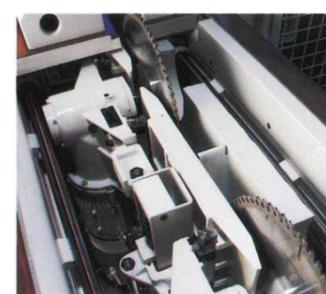
Sägewagen mit zwei obenliegenden Führungen aus gehärteten und geschliffenen Wellen auf Super-Kugelführungsbüchsen geführt.
