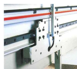
Vollautomatische Winkelangleichrichtung mit pneumatisch betätigter Anpreßklaue.
