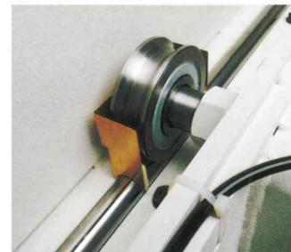
Führung des Materialvorschubers über gehärtete Formrollen und gehärtete Rundachsen.
