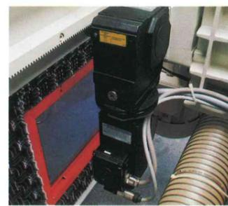
Absaugung als geschlossenes System mit direkt angeschlossenem PU-Spiralschlauch ergibt einen optimalen Wirkungsgrad. Die berufsgenossenschaftlichen Grenzwerte werden deutlich unterschritten.
